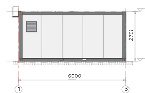
Élévation grille A
